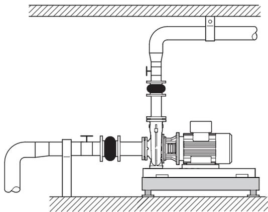
Рис. 8 Монтаж насоса NBGV
