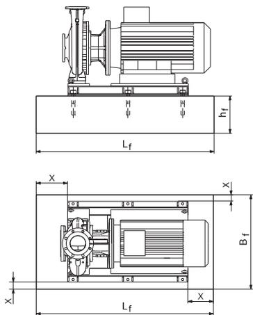
Рис. 4 Фундамент, X = мин. 100 мм
