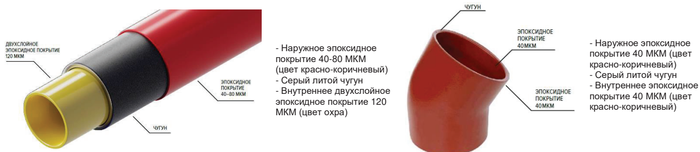
Рис. 1 Материал и покрытие труб и фитингов SML
